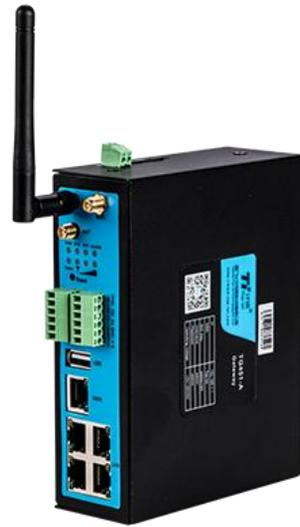
TG451双模双卡系列网关是一款工业级物联网无线网关，设计完全满足工业级标准和工业用户的需求，采用高性能的工业级32位通信处理器，软件多级检测和硬件多重保护机制来提高设备稳定性。支持中国电信5G/4G/3G，中国联通5G/4G/3G、中国移动4G/3G并往下兼容EDGE、CDMA 1X及GPRS网络，同时支持多种VPN协议（OpenVPN、IPSEC、PPTP、L2TP等）来保证数据传输的安全性。支持4×LAN、1xWLAN、1xUSB、SIM卡、2×继电器（可选）、1×RS232(1×RS485)、1×RS485、2×DI、Wifi功能。
