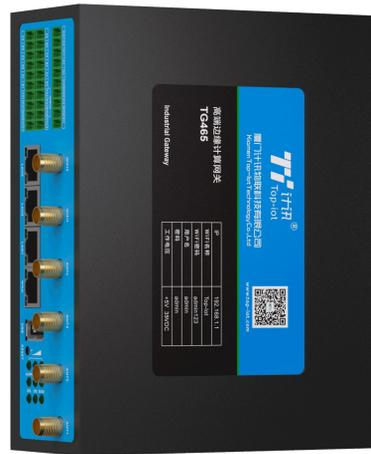
TG465系列网关是一款工业级高端边缘计算网关，CPU采用四核64位Cortex-A55，主频高达2GHZ, 具有超强的运算能力。设备具有多功能性、稳定性和可扩展性，具有速度快、功能强、支持边缘计算的特点。具备人脸识别及视频深度分析能力。支持全网通5G/4G/3G，并往下兼容EDGE、CDMA 1X及GPRS网络，同时支持多种VPN协议（OpenVPN、IPSEC、PPTP、L2TP等）来保证数据传输的安全性。可无缝对接各类PLC工业组网应用。可选嵌入水利、环保行业标准规约。支持3×LAN、1×WAN、1×USB2.0，1×USB3.0、1×RS232(复用其中1路RS485)、6×RS485、4×DO、4×DI、SIM卡、TF卡、WIFI6功能、HDMI（非标配）、固态硬盘NVMe SSD(非标配)、单模双卡(非标配)、断电告警（非标配）。
