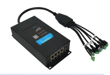
TG473-A4-1二代智慧杆网关是专为智慧杆场景设计的千兆智慧网关,可用于替代传统路由网关、交换机、光猫、集中器等设备的组合应用,它集成了包括数据采集系统、网络路由和交换系统、灯控系统和边缘策略系统,配合智慧杆综合管理平台、物联网设备管理平台运用,实现智慧城市闭环应用。支持接入智能照明、安防监控、环境监测、无线覆盖、信息发布、网络广播、应急报警、市政设施监控和充电桩等外设,支持外设的单控、集控和联动等的策略管理。其设计充分考虑多功能性和稳定性,基于物联网技术架构设计,可以满足智慧终端设备的数据收集和智能控制;同时具备扩展性,方便在现有硬件下实现新设备接入。具有速度快、功能强、支持边缘计算的特点。
