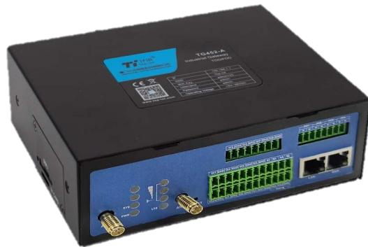
TG452-A2 Gateway是一款工业级物联网无线网关，设计完全满足工业级标准和工业用户的需求，采用高性能的工业级32位通信处理器，软件多级检测和硬件多重保护机制来提高设备稳定性。支持中国电信、中国联通、中国移动4G并往下兼容、3G EDGE、CDMA 1X及GPRS、LoRa等网络，同时支持多种VPN协议（OpenVPN、IPSEC、PPTP、L2TP等）来保证数据传输的安全性。支持1×LAN、1×WAN、TF卡、2×RS232、2×RS485、2×ADC、8×DI、4×继电器、GPS功能（可选）、单模双卡（可选）、双模双卡（可选）、LoRa（可选）。
