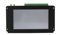
TG462 系列工业级物联网网关是一款采用ARM架构高能效处理器作为主控、采用Linux作为操作系统的嵌入式工业计算机。它结合开放、先进的软件功能,在工业应用现场端和平台服务器端作为通讯枢纽,实现工业现场的数据采集、通信协议转换和数据传输,为工业领域设备信息化和工业大数据应用提供高效、可靠的数据通道。
